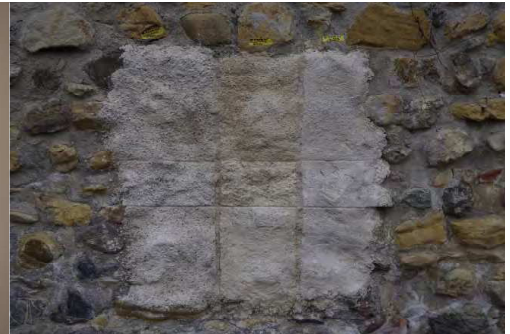
Abb. 5 - Probefeld 2 - Fassade Süd. Links=Putzmuster FPM1, Mitte FPM2 und rechts FPM3
