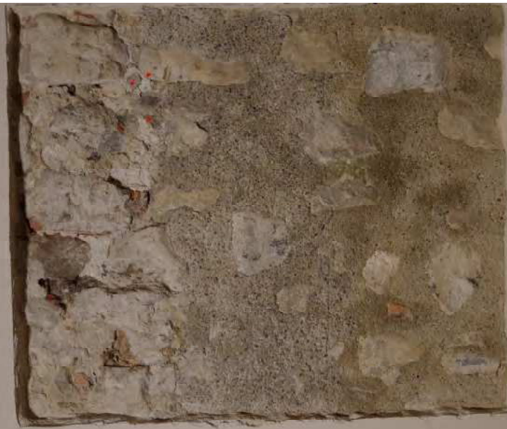
Abb. 3 - Probefeld 1 - Innenraum - S0.13Wc. Rechts Putzmuster RPM1, Mitte RPM2- Bis auf die etwas dunkleren Flecken ist die Putzoberfläche weitestgehend trocken.
